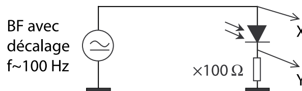
FIG. 1 – Montage de la photodiode pour la caractéristique courant-tension
