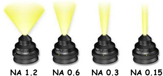
L'ouverture du diaphragme de condenseur est responsable de l'angle du cône d'illumination et par conséquent de l'ouverture numérique du condenseur
